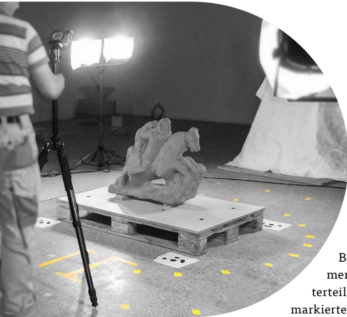
Oben: Der technische Aufbau basiert auf dem Structure-from-Motion-Verfahren, das mithilfe von 24 unterschiedlichen Kamerawinkeln eine präzise Erfassung und Rekonstruktion von 3D-Strukturen und -Formen ermöglicht. (Grafik: BLfD, Elisabeth Frick) Links: Structure-from-Motion Vermessung der Jupiterfigur Neben dem Kameraaufbau und der gleichmäßigen Ausleuchtung durch mehrere Scheinwerfer sind am Boden zudem die gelben Markierungen der Aufnahmestandorte sowie die Passpunkte für die Maßbestimmung erkennbar. (Foto: BLfD, Tatjana Gericke)
