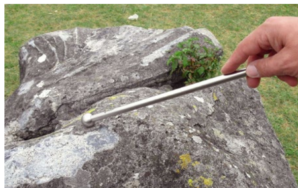
Detektion von Hohlstellen mit dem Kugelstab (Foto: BLfD, Christoph Sabatzki)
