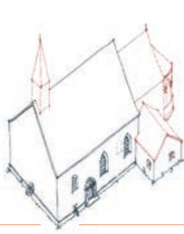
BAUPHASE 2 Erster Umbau
