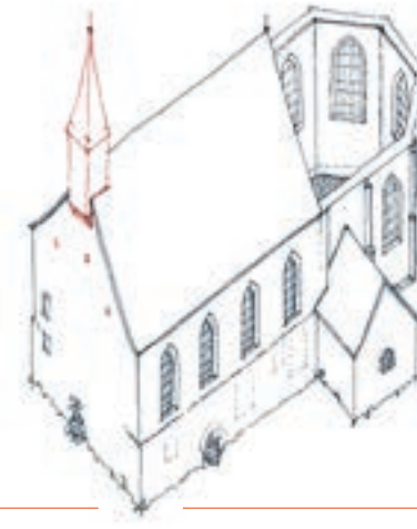
BAUPHASE 4A Spätgotisches Bauprogramm I Chorneubau
